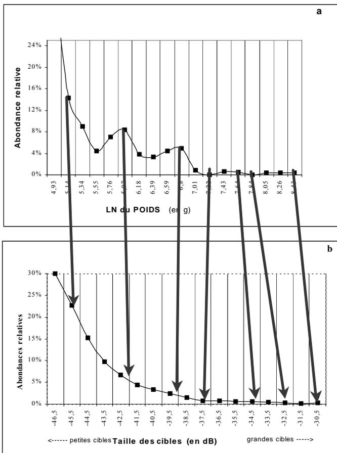
Figure 10 : Anamorphose entre les abondances relatives des poissons capturés (a) et les abondances relatives des cibles acoustiques (b) dans la retenue du barrage de Sidi Salem
