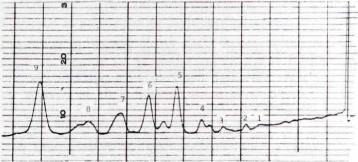
Fig. 3 : Chromatogramme d'une solution étalon contenant 0,5 ppm d'A-roclor 1260.
